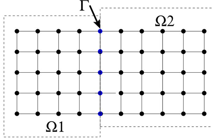
Figure 2: Décomposition de domain sans recouvrement, méthode du complément du Schur.
