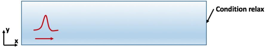
FIGURE 2.3 – Onde se propageant dans un conduit.
