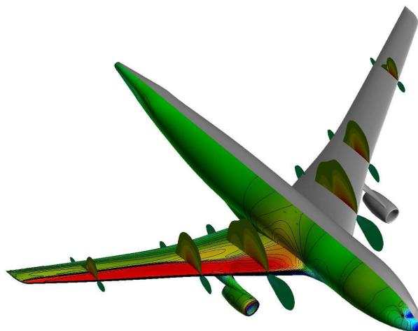
FIGURE 1 – Optimisation de la traînée d'un avion (*cerfacs.fr*)
