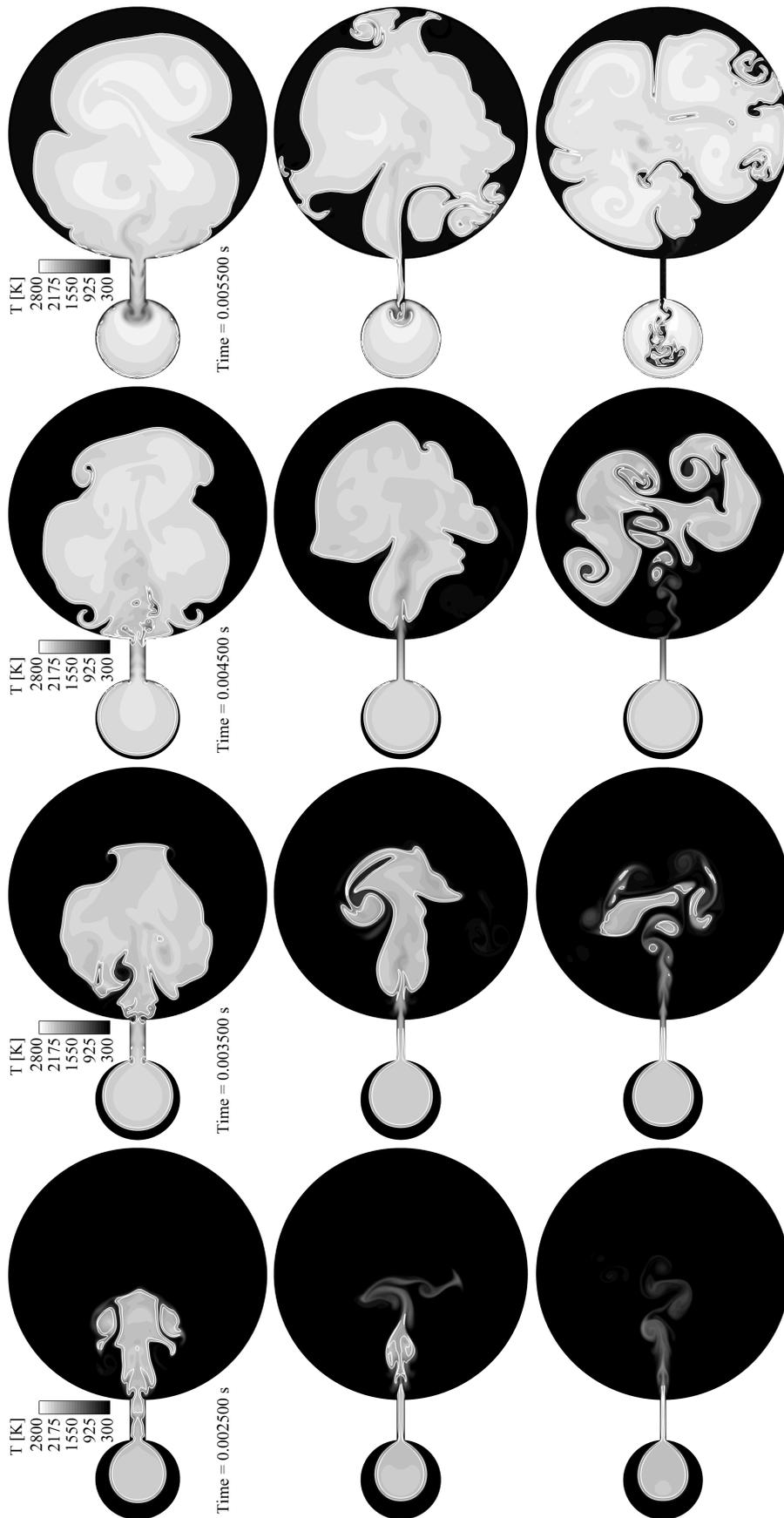
FIGURE 8.3 – Visualisation de la température et d'un iso contour à  $HR = 10^8 \text{ W m}^{-3}$  pour 3 hauteurs et 4 instants différents. Condition initiale :  $P = 1 \text{ bar}$ ,  $K = 300 \text{ K}$  et  $\Phi = 1$ . De haut en bas :  $d = 2 \text{ mm}$ ;  $d = 1 \text{ mm}$ ;  $d = 0.75 \text{ mm}$ .
