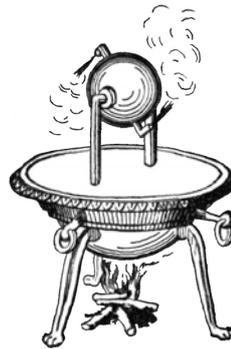
FIGURE 1.1: Illustration de *l'aeolipile* de Heron.
