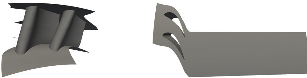
FIGURE 3.4 – Vue d'ensemble des pales fixes de turbine de la configuration FACTOR.
