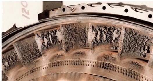
FIGURE 2 – Effets des cendres volcaniques sur les pales d'une turbomachine [31].
