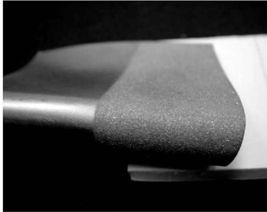
FIGURE 1.2 – Augmentation de la rugosité de surface d'une pale par érosion [25].
