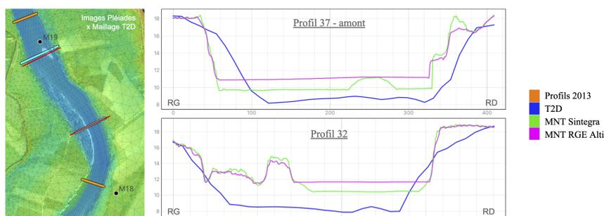
**Figure 2.8:** Comparaison des données bathymétriques/topographiques issues des levés in-situ 2013 (en orange), du modèle T2D (en bleu), et des MNT Sintegra (en vert) et RGE Alti (en magenta), pour 2 tronçons, notés 37 et 32 où les MNT montrent la présence récente de dépôts pérennes dans la rivière.
