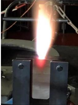
Pour ce stage on étudiera le passage de C<sub>3</sub>H<sub>8</sub> à H<sub>2</sub> sur des flammes stabilisées en oxycombustion. La simulation permettra d'étudier l'accrochage de la flamme, sa longueur, le champ de vitesse induit.
